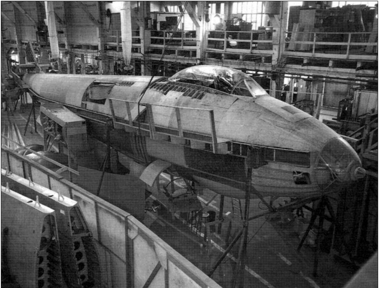
Снимок деревянного макета В-47. Видны плексигласовый фонарь кабины пилотов и аварийный люк штурмана, через который он катапультируется в своём кресле. Макет ускорителей RATO стоит отдельно, чуть слева. В левом нижнем углу видны макеты двух стабилизаторов. Фото: «Боинг».
