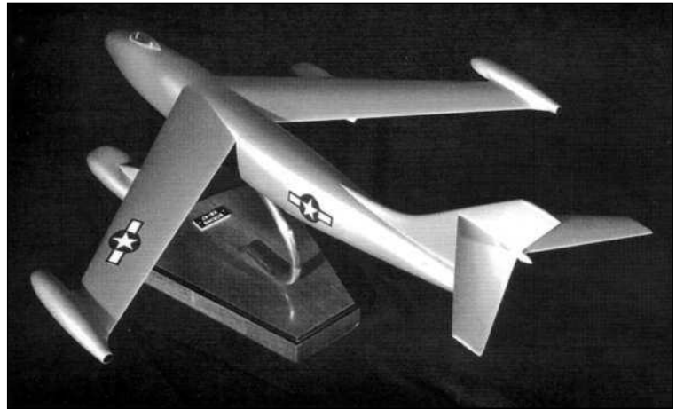
На снимке модель 450, которая имела большое сходство с окончательной версией В-47. Только периферийные двигатели были установлены на законцовках крыла. Фото: «Боинг».
