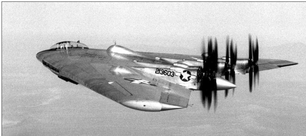
Летающее крыло фирмы «Нортроп» — ХВ-35. Каплевидный фонарь кабины пилотов обеспечивает круговой обзор. Моторы имеют соосные винты. Функцию киля выполняют большие мотогондолы моторов.
