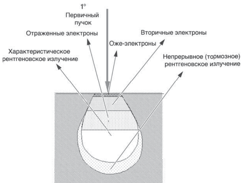
Рис. 1.2. Иллюстрация различных сигналов, генерируемых в процессе взаимодействий электронного пучка с образцом в РЭМ, и областей, из которых эти сигналы могут детектироваться
