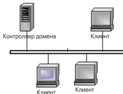
Рис. 1.28. Сеть с физической топологией «шина»
