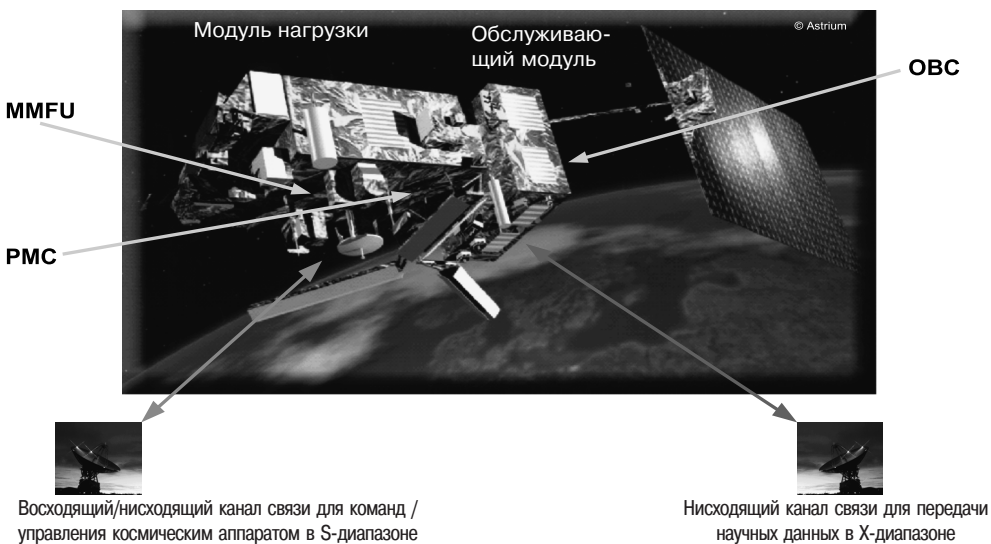
Рис. 1.1. Модульный спутник и его бортовые компьютеры
